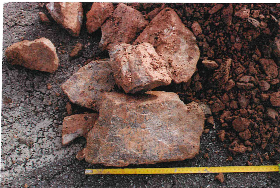
Obr.10: Kamenivo (štěrkodrt') o rozměrech zrn vyšších než 200 mm
